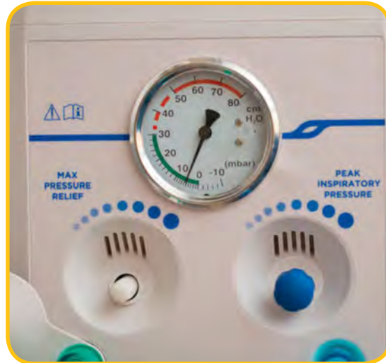
شکل ۴الف. ۱۰ PEEP را تنظیم کنید
